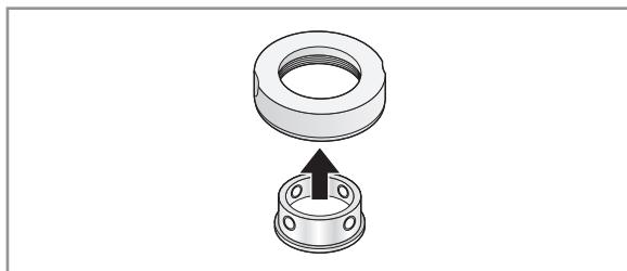
4 蛇口に分岐水栓のパッキンが密着するように押し上げる
