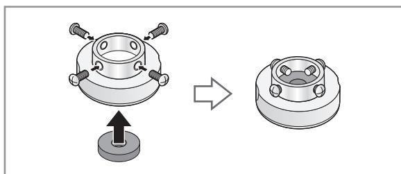
5 締付キャップをしっかりと締め付ける
