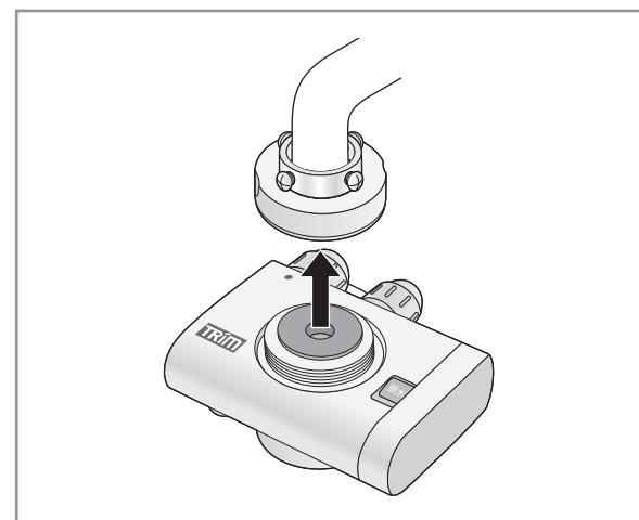
2 ねじ4本をねじ止め金具に仮止めし、平パッキンを挿入する
