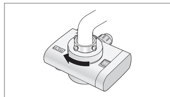
3 蛇口がねじ止め金具の中心になるようねじで固定する
