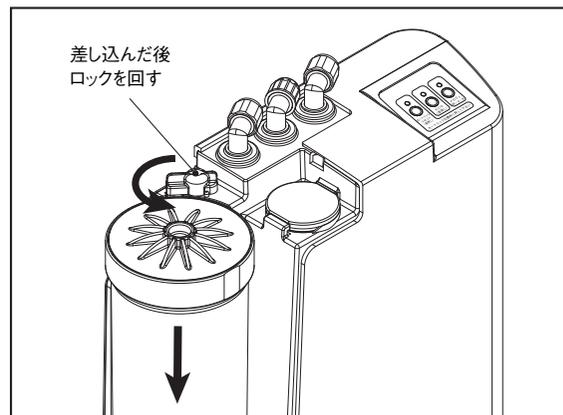
※カートリッジを差し込んだ後、必ずロックしてください。ロックが不十分だと水漏れの原因となります。(ロックが不十分な場合、カートリッジカバーを正しく取り付けることができません。)
