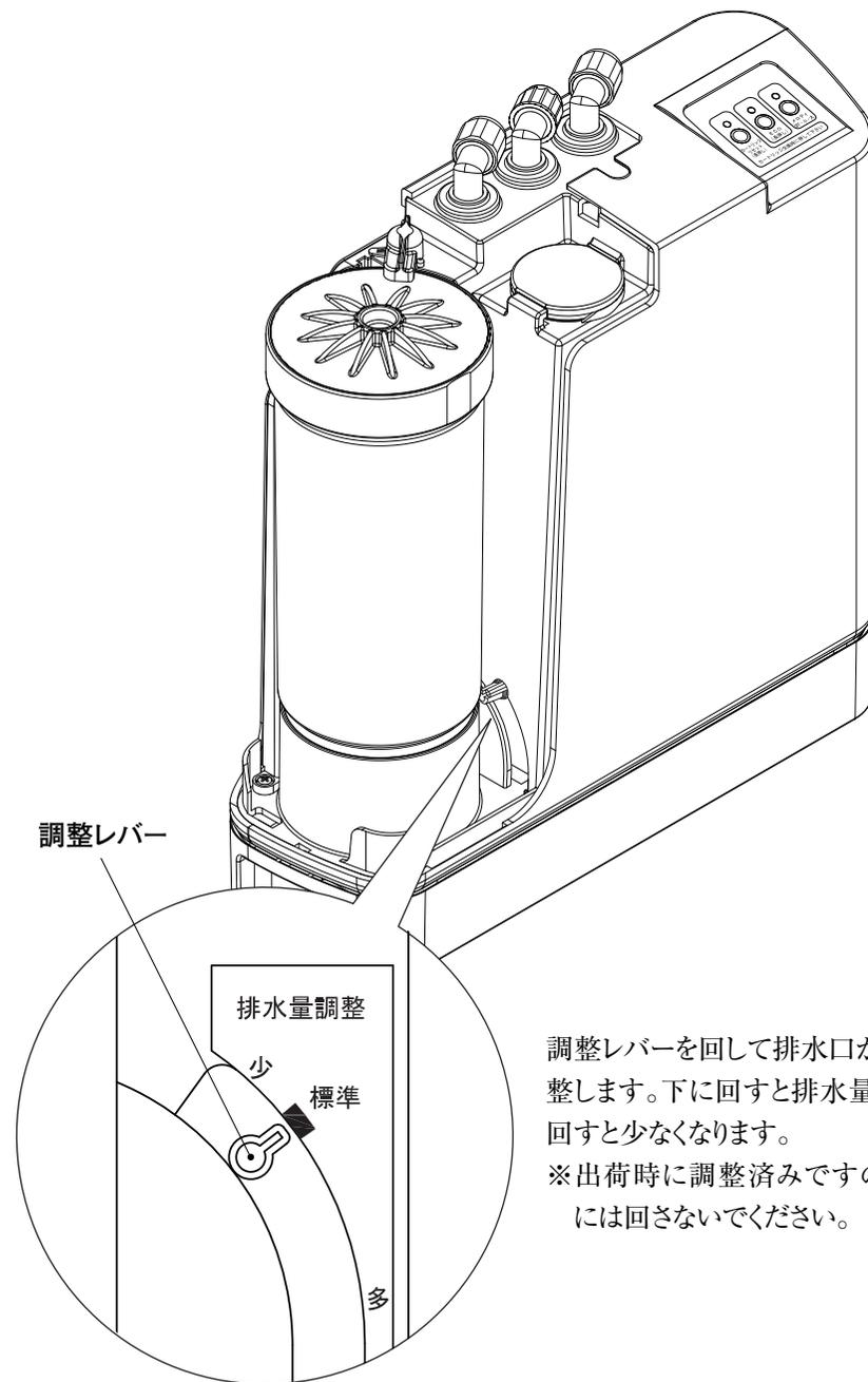
調整レバーを回して排水口から出る水量を調整します。下に回すと排水量が多くなり、上に回すと少なくなります。
