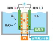
陽極反応 2H<sub>2</sub>O → O<sub>2</sub> + 4H<sup>+</sup> + 4e<sup>-</sup>
