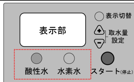
取水切替スイッチ
